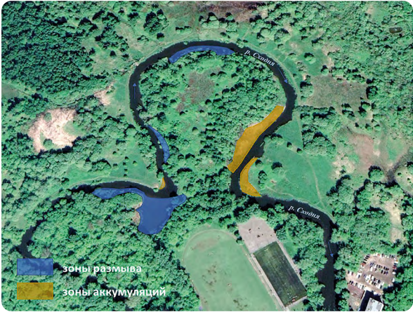
Рисунок 2.33 – Схема развития зон размыва и аккумуляций на примере меандра на р. Сходне
