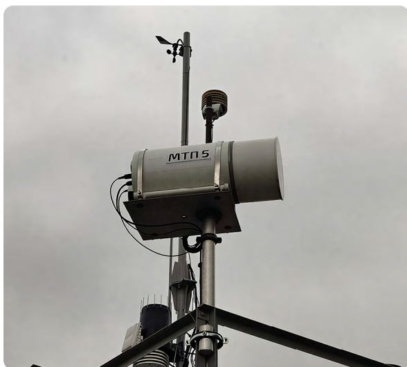
Рисунок 2.3 – Метеорологический температурный профилемер МТП-5
