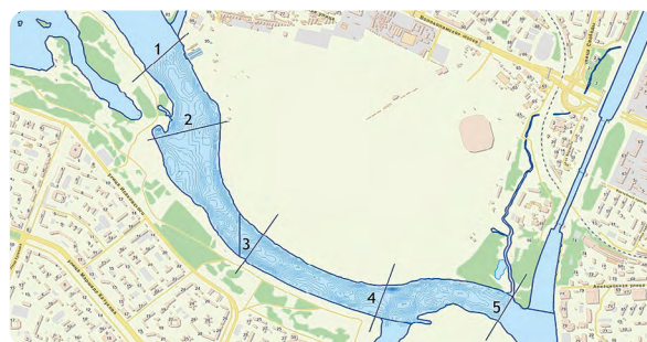
Рисунок 2.35 – Пример расположения контрольных створов на участке переработки левого берега между устьями рек Сходня и Химка на р. Москве
