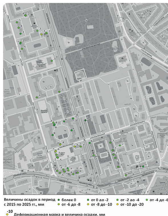
Рисунок 2.74 – Карта вертикальных смещений деформационных марок на зданиях на участке Ходынский (восточная часть) за период 2015–2025 гг.
